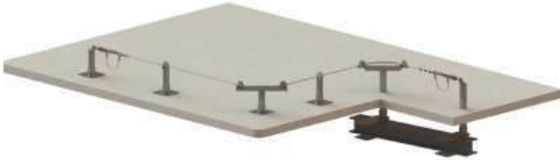
Příklad montáže systému DUO na povrch ploché střechy
